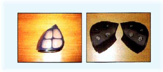
รูปที่ 2 สวิตช์ยางซิลิโคนเคลือบด้วยโพลียูรีเทน
