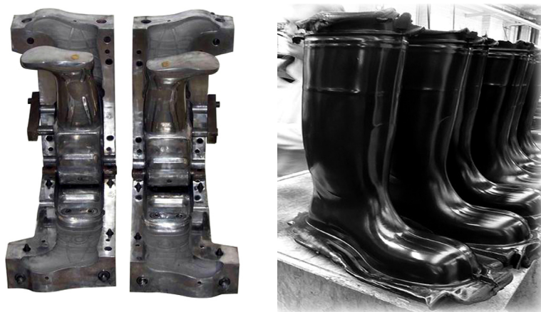
รูปที่ 4 ตัวอย่างแม่พิมพ์แบบอัดและชิ้นงานรองเท้าบูทที่ยังไม่ผ่านการตกแต่งชิ้นงาน
