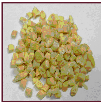
รูปที่ 1 เม็ดยางธรรมชาติเทอร์โมพลาสติกที่พัฒนาขึ้น
